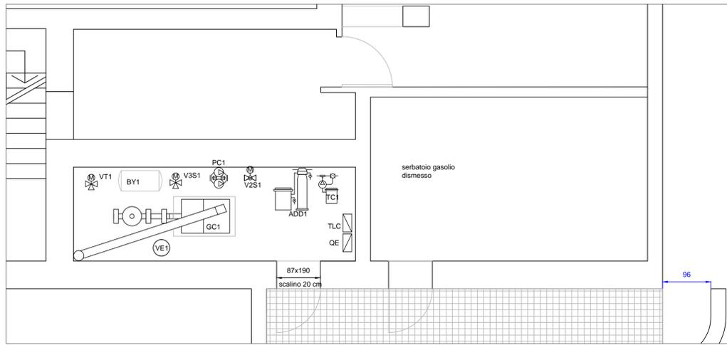
Pianta locale CT con disposizione componenti principali - Scala 1:50
