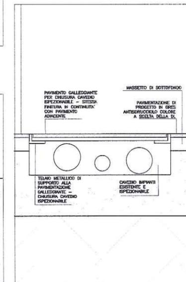
PARTICOLARE COSTRUTTIVO CAVEDIO IMPIANTI ISPEZIONABILE CON CHIUSURA IN PAVIMENTO GALLEGGIANTE - DA ESEGUIRE SECONDO INDIRIZIONI DELLA DL SCALA 1:20
