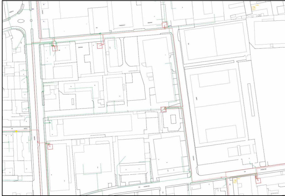
Fig. 3 - Rete elettrica (estratto via Albert Einstein) Enel Spa – BT colore verde, MT colore rosso
