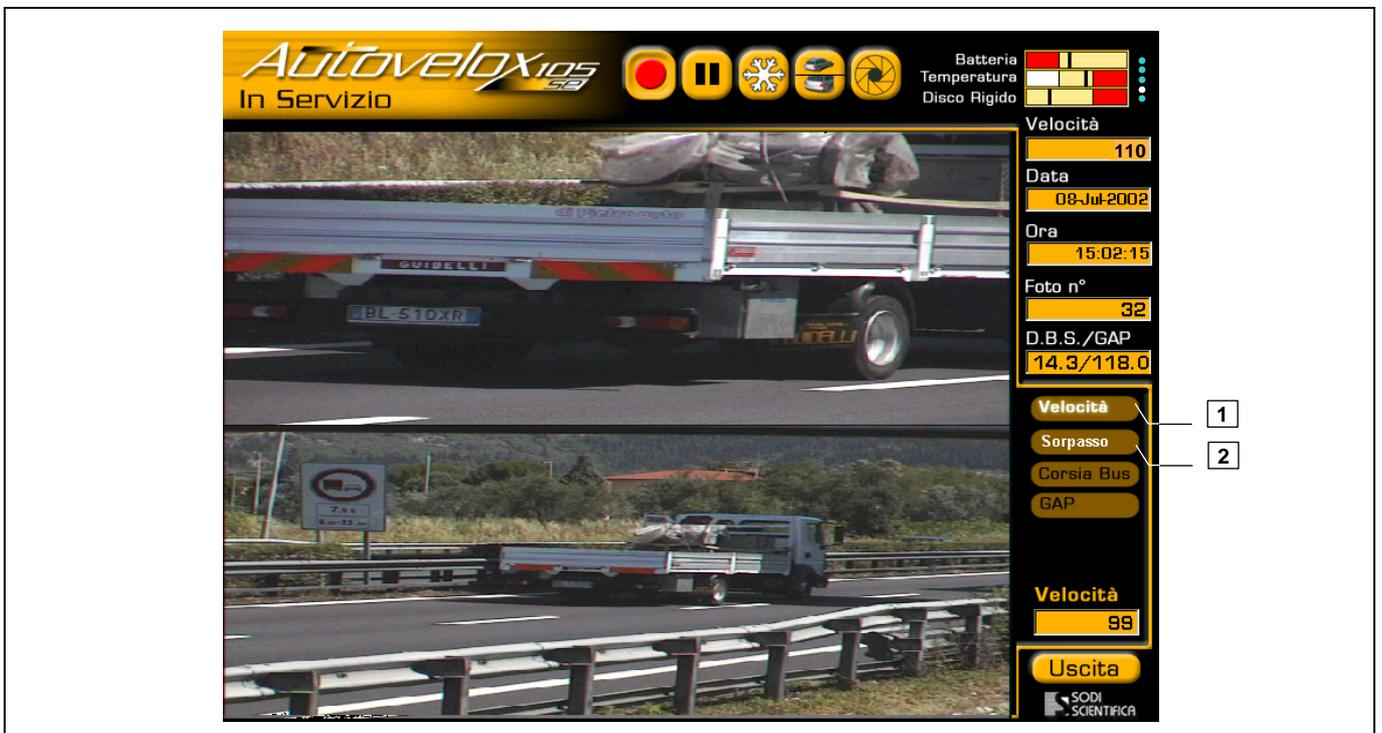
In figura è mostrato un esempio tipico di infrazione per transito su corsia non consentita ai veicoli pesanti. L'accensione dell'etichetta **Sorpasso** (1) indica il tipo di infrazione effettuata dal veicolo, inoltre l'accensione dell'etichetta **Velocità** (2) indica che il veicolo superava anche il limite di velocità massimo consentito.
