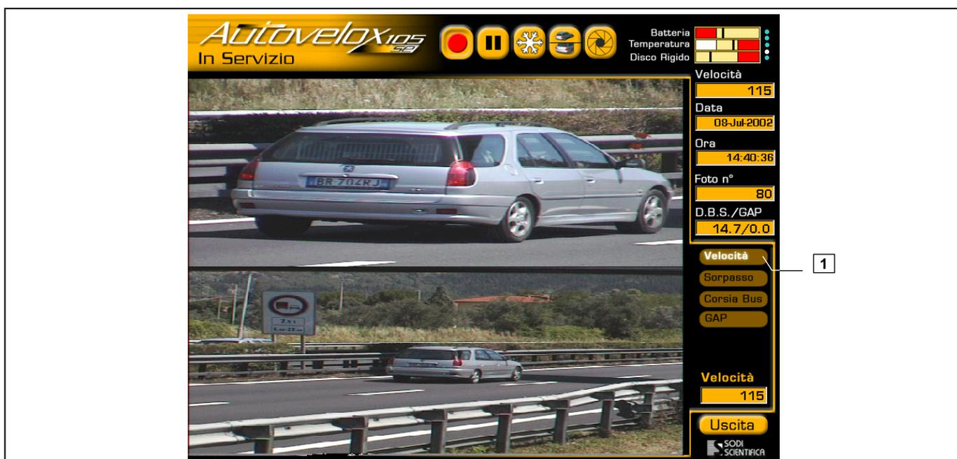
In figura è riportato un esempio di infrazione per velocità di un autoveicolo. L'accensione dell'etichetta (1)
