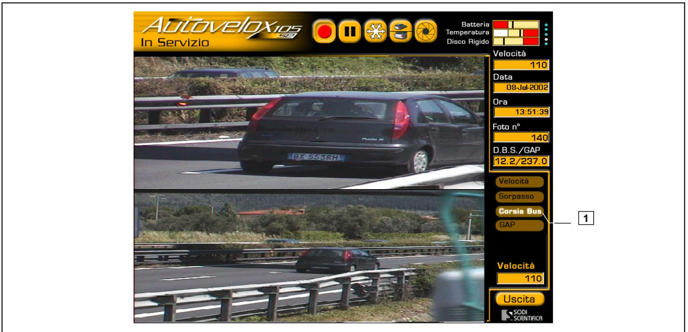
In figura è mostrato un esempio tipico di infrazione per transito su corsia riservata ai BUS. L'accensione dell'etichetta **Corsia Bus** (1) indica il tipo di infrazione effettuata dal veicolo.
