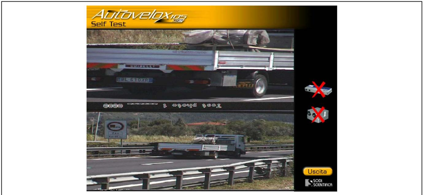
I segni “ X ” rossi indicano che il sistema ha rilevato delle anomalie di funzionamento sulla barra laser e sul movimentatore. In questo caso controllare che tutte le apparecchiature siano collegate correttamente, che i cavi siano in buono stato che nessun oggetto impedisca la rotazione del gruppo telecamere, eseguire di nuovo il test. Se il problema persiste consultare la SODI SCIENTIFICA S.p.A..
