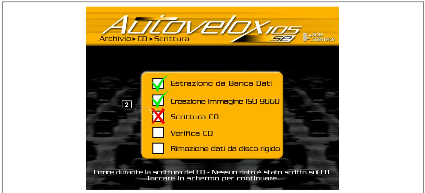
Fig. 28 - Errore di masterizzazione
