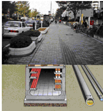
Strada infrastrutturata con cunicolo tecnologico
