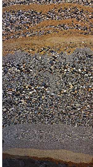
Esempio di stratigrafia con sequenze alluvionali ghiaioso - sabbiose alternate a materiale sabbioso e limoso.
